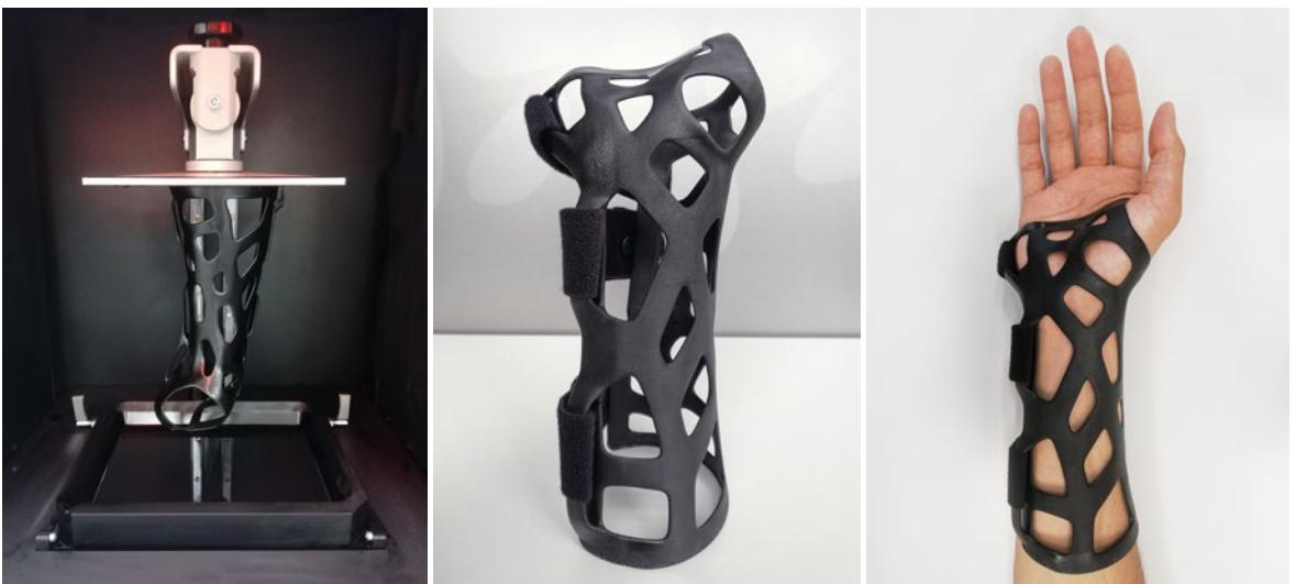
Beispiel einer 3D-gedruckten, patientenspezifischen Vorderarmgipsschiene
