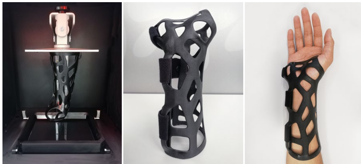
Beispiel einer 3D-gedruckten, patientenspezifischen Vorderarmgipsschiene
